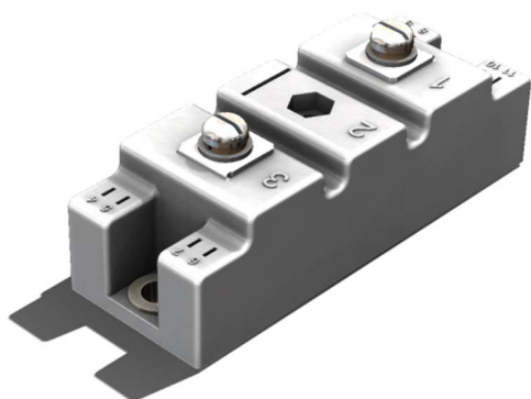
Рис. А.3 корпус П1, П1П (высоковольтный, потенциал на подложку) габаритные размеры: 94x34x35 мм
